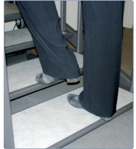
Der StairTrainer kann mit unterschiedlichen Stufenhöhen von 2,5 bis 19,5 cm eingestellt werden.
