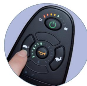
Die Geschwindigkeit kann reguliert werden. Auf einer Anzeige ist der Ladezustand der Batterie gut ablesbar.
