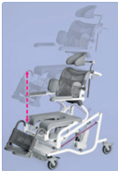
Bild unten: Höhenverstellbarkeit der Sitzfläche reicht von 49 bis 103 cm
