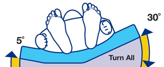
\* Falls das System beim Start nicht hebt, beginnt es mit der Rückenlage. Um direkt mit einer 30°-Positionierung zu beginnen, schalten Sie die Pumpe für 5 Sekunden über den Ein-/Aussschalter aus und dann wieder ein.
